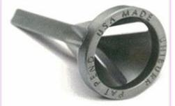
頭がつぶれたりネジ溝がつぶれたボルトの先端を60度の角度に切削して、再利用可能にします。手持ちの電動ドリルに装着して用います。適合ボルトM5~M19
